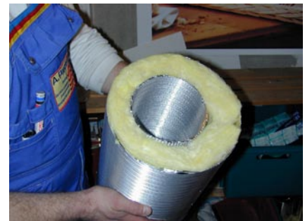
Ein Schalldämpfer ohne Abdeckblech: Innen das fein gelochte Wellrohr, darum die Schallschluckmatte.
