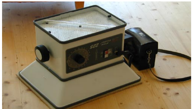
Ein Messgerät zur Bestimmung der Volumenströme an Zu- und Abluftventilen
